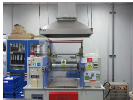
ภาพที่ 2.2-53 ภาพการติดตั้งระบบป้องกันไอสารเคมี (Filter)
